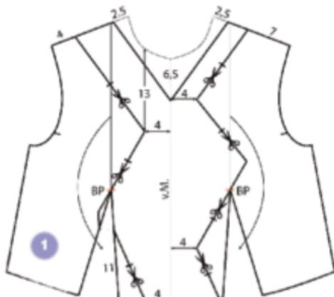
так можно будет точно соединить части деталей по новым линиям. После этого макет разрезается по новым модельным линиям (базовые вытачки не распираются, они уже «автоматически» переведены в новые линии изделия). По полученным лекалам из основного материала выкраиваются детали изделия с припусками на швы по зигзагу.
