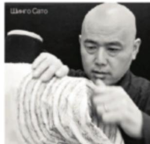
**C** начала из базы выполняется макет базовой конструкции изделия (на макете обработаны вытачки и соединительные швы). Макет надевается на манекен, и затем на макете чертятся новые модельные линии изделия. При этом важно отметить монтажные контрольные знаки для последующего соединения деталей. Особенно важно правильное расположение знаков и их количество на линиях сложной изогнутой формы. Только
